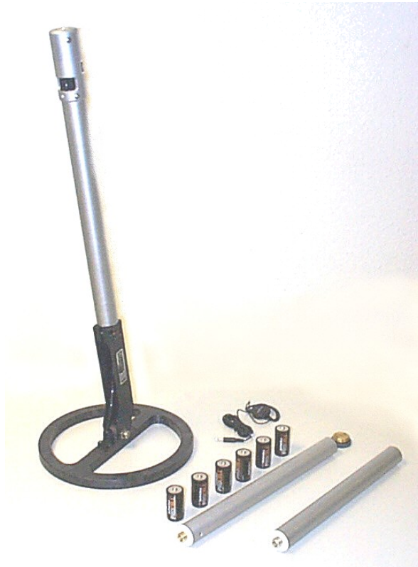
1. kép EB 450 S szilánkkereső szétszedve, hosszabbítóval és fülhallgatóval.
