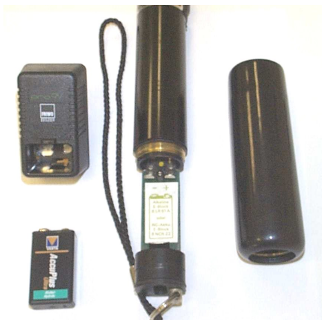
3. sz. Kép: EB 607 kézidetektor lecsavart akkutartóval, Ni-MH akkuval és töltővel
